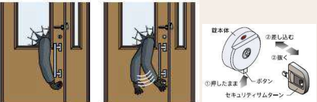
従来のサムターン セキュリティサムターン（取り外した状態）
